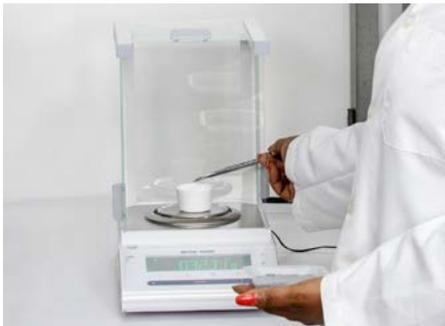
るつぼの重量をはかり、サンプルの重量を計測してください。
