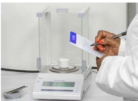
Pese el crisol con las cenizas, para obtener el resultado final.
