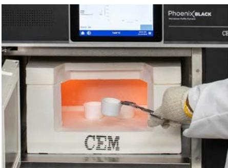
Coloque la muestra en el horno de la mulfa.
